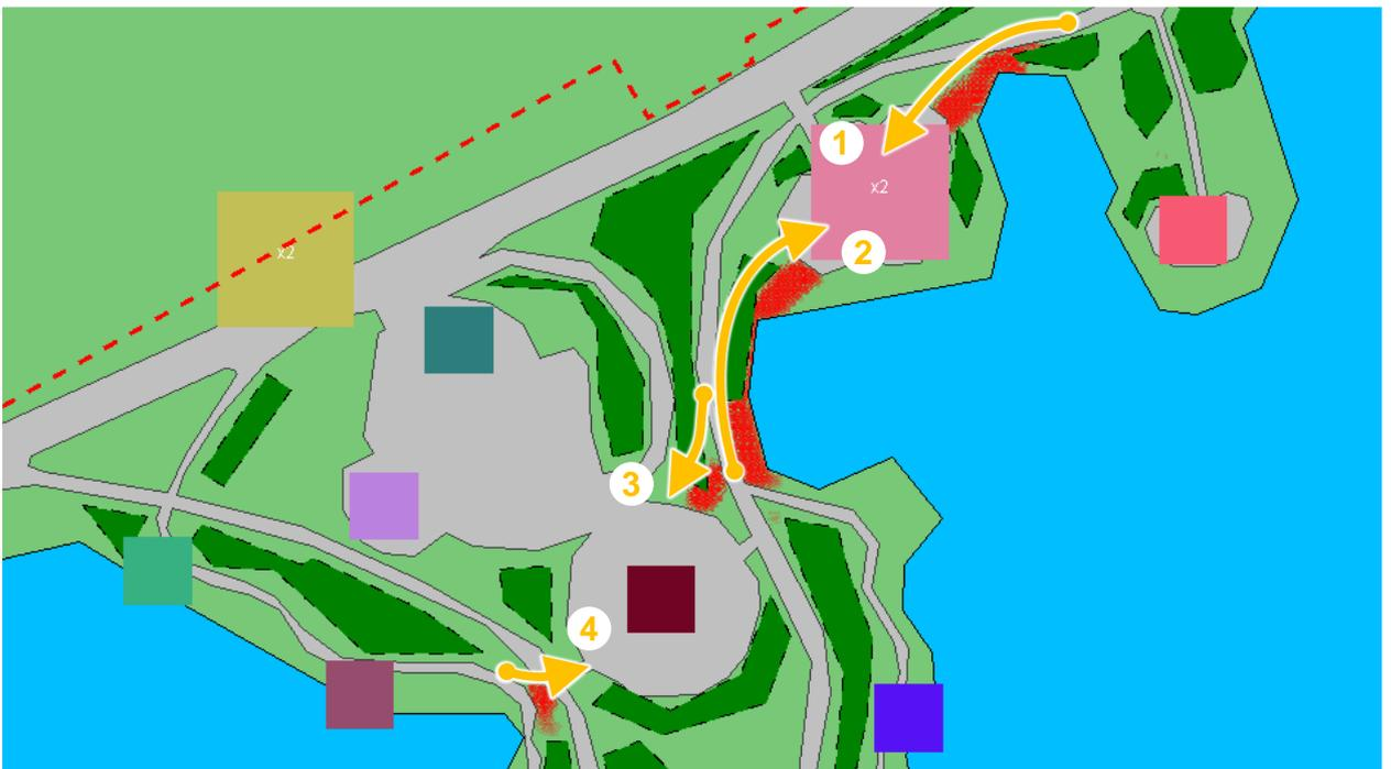
Рисунок 53. Отсутствуют входы на площадки с углов (1, 2, 3), не соединяются близко идущие дорожки (4)
